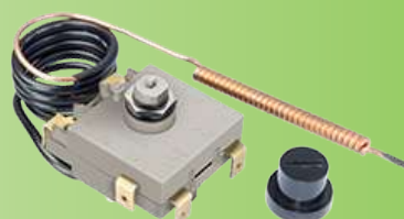
Termostato bipolare a reset manuale ad alto limite, Fail-Safe, impostazione fissa, intervallo di temperatura fino a 170°C
